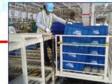
ทดลองการเคลื่อนย้าย Box Small Part เข้าชั้นวาง
